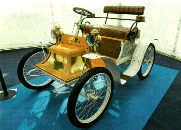
CLÉMENT DE 1898, DEL COCHE DE CABALLOS A LA COMBUSTIÓN. Uno de los primeros automóviles, todavía con muchos elementos del coche de caballos, es este Clément con motor de dos cilindros en V, cuya marca acabaría siendo Clément-Bayard y después Talbot.
